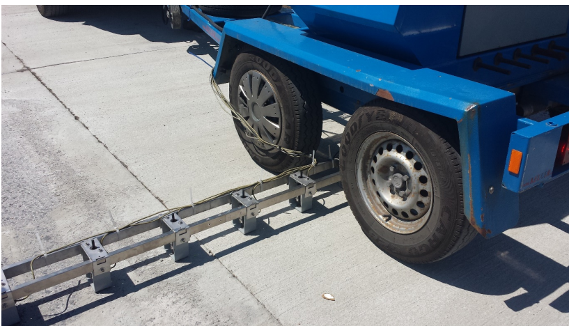
Abb 1. Innovative Messungen mit dem Fallgewichtsdeflektometer
